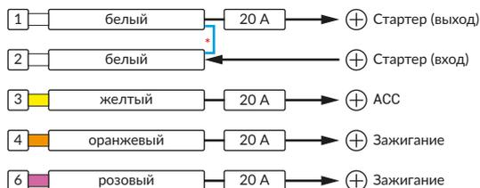
\* Для реализации защиты от включения пользователем стартера при работающем автозапуске подключение должно быть произведено в разрыв провода стартера. При этом в режиме автозапуска сигнал с входа не передается на выход, но по этому сигналу автозапуск выключается. Если подключение производится без разрыва, вход стартера не используется.
