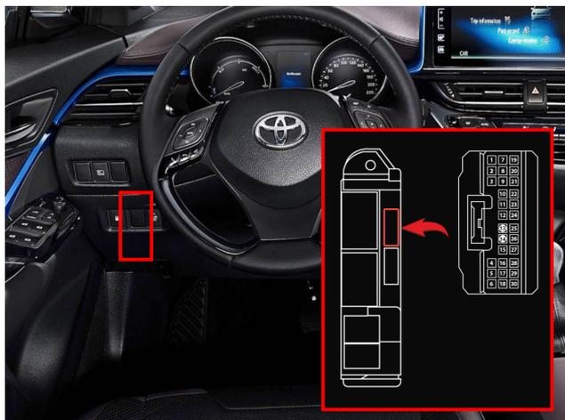
Рис.2 Место подключения CAN 1
