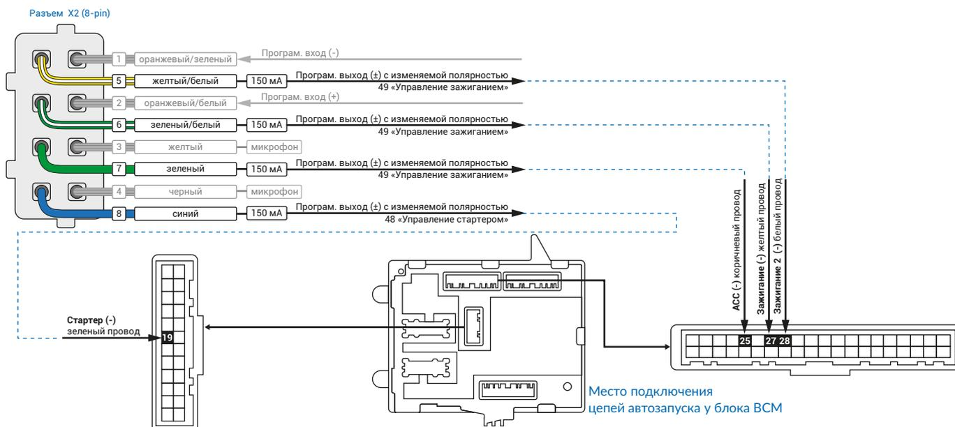
Рис.1 Схема подключения автозапуска
