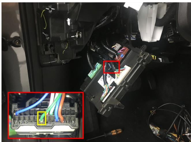
Рис.2 Подключение Стартера
