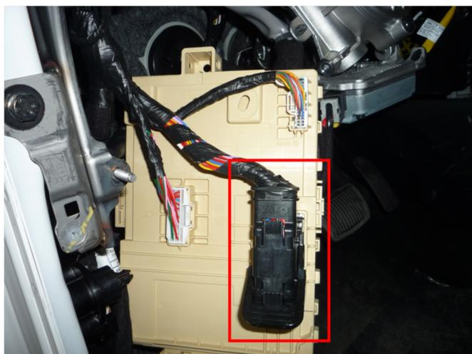
Рис.5 Место подключения к силовым цепям запуска двигателя
