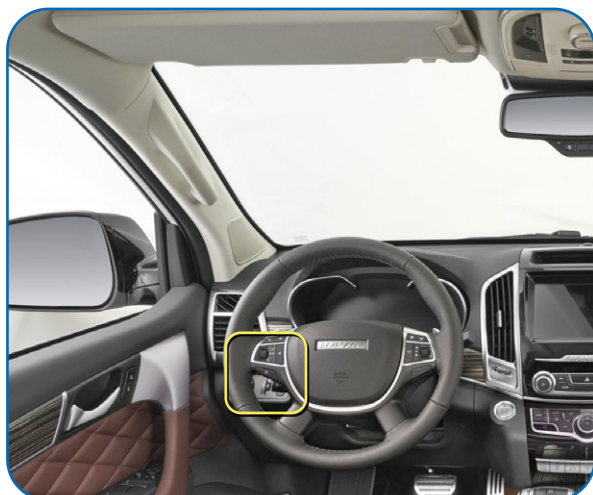
Примерное место размещения центрального блока
