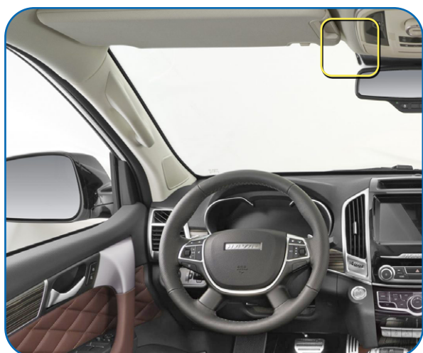
Примерное место размещения микрофона*
