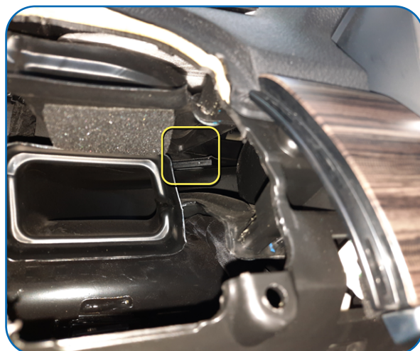
Примерное место размещения модуля GPS/ГЛОНАСС-270*
