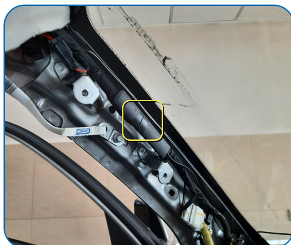
Примерное место размещения выносной GSM антенны*
