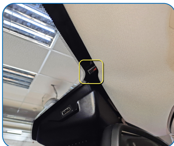
Примерное место размещения микрофона*
