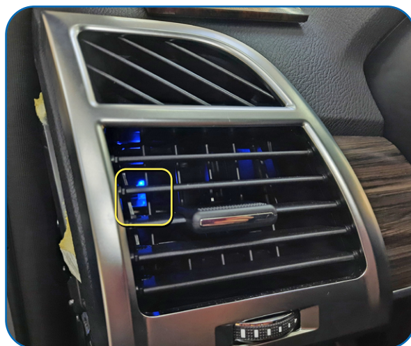
Примерное место размещения светодиода центрального блока
