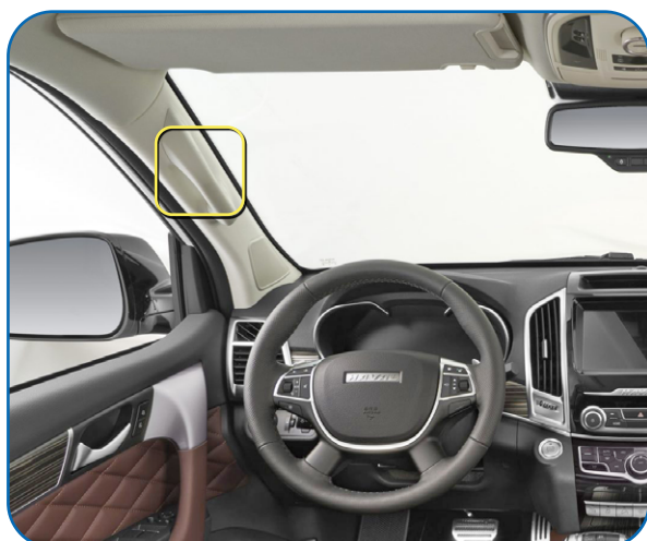
Примерное место размещения выносной GSM антенны*
