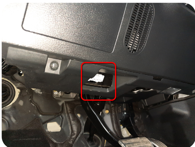
Подключение в белом 16-контактном разъеме OBD II слева от рулевой колонки
