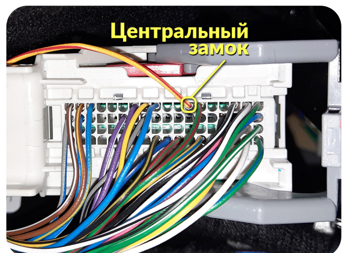
Центральный замок – желто-красный провод, контакт № 7 «-»
