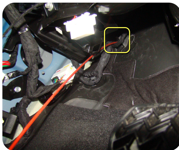
Штатный уплотнитель. Вид со стороны салона
