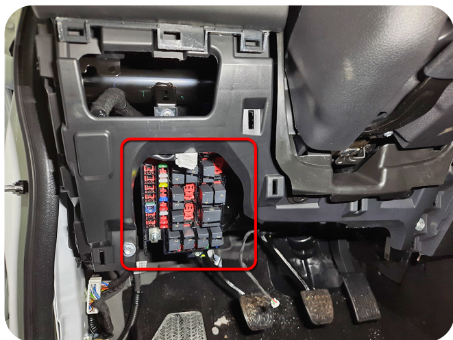
Подключение в белом 12-контактном разъеме блока PEPS справа за перчаточным ящиком
