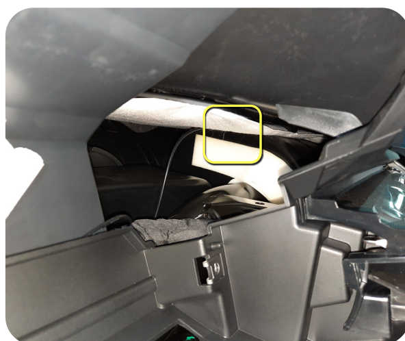
Примерное место размещения выносной GSM антенны*
