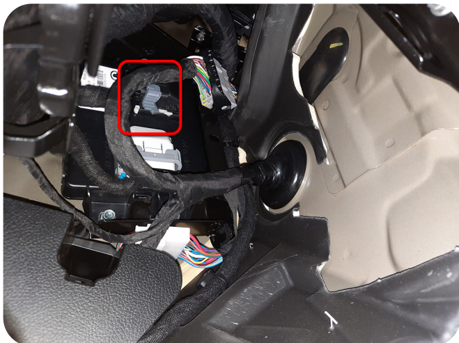
Подключение в черном 56-контактном разъеме блока ВСМ слева от рулевой колонки
