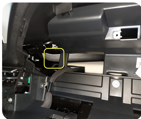
Примерное место размещения модуля GPS/ГЛОНАСС-270*
