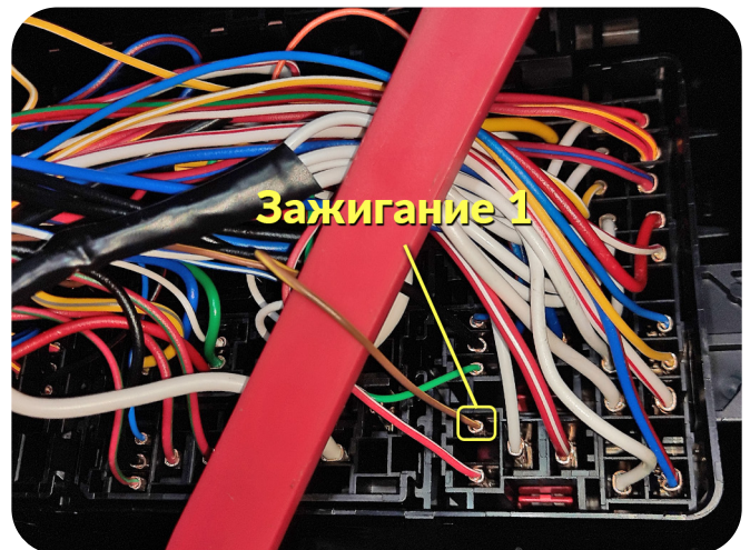
Зажигание 1 – коричнево-желтый провод, контакт №85, R104 «-»
