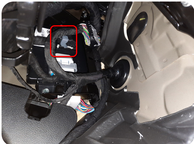
Подключение в черном 56-контактном разъеме блока BCM слева от рулевой колонки
