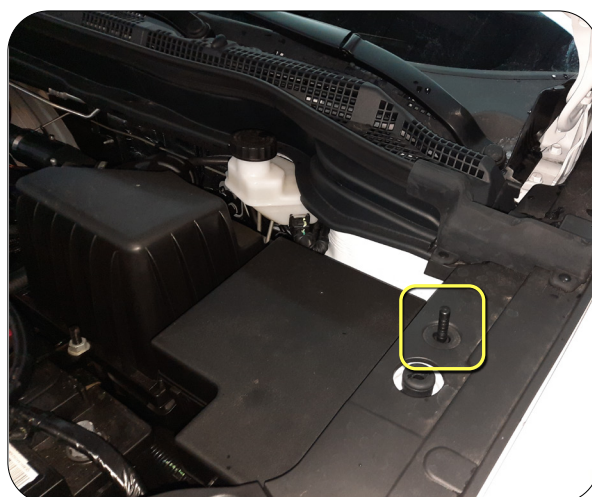
Примерное место размещения концевика капота
