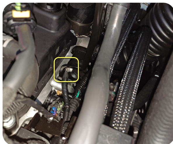
Примерное место размещения датчика температуры двигателя
