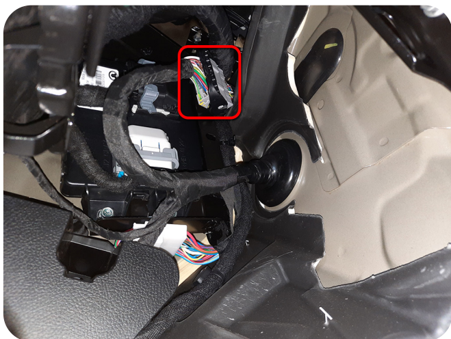
Подключение в сером 40-контактном разъеме слева от рулевой колонки
