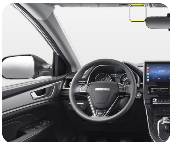
Примерное место размещения микрофона*
