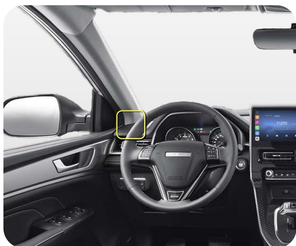
Примерное место размещения модуля GPS/ГЛОНАСС-270*
