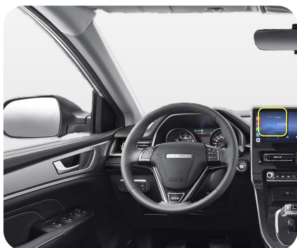
Примерное место размещения выносной GSM антенны*
