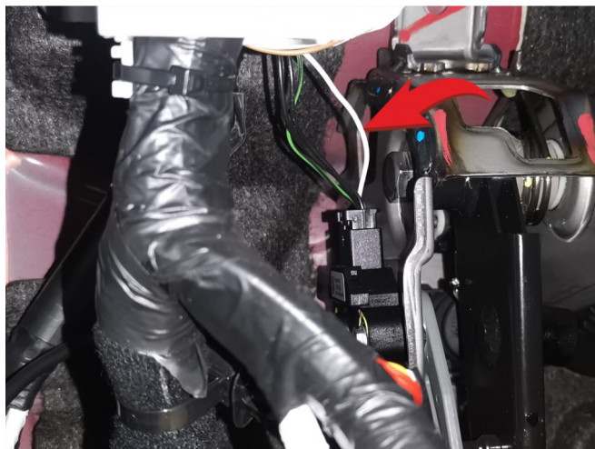
Имитация нажатия педали сцепления «+» (белый провод)
