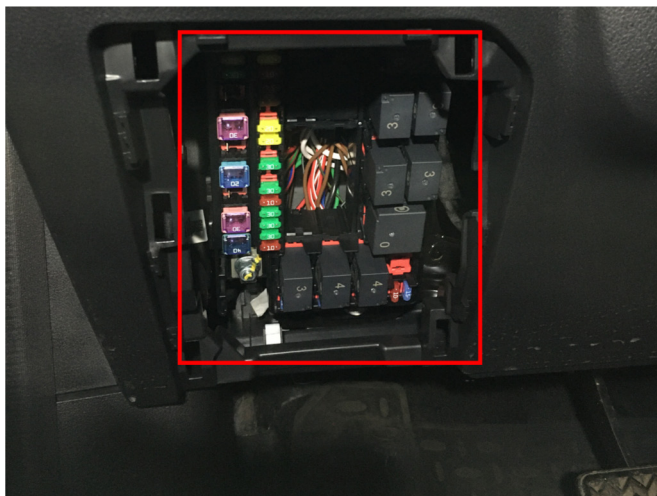
Место подключения к цепям запуска двигателя
