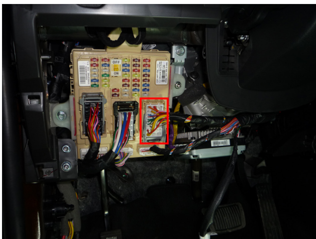
Рис.5 Место подключения к силовым цепям запуска двигателя
