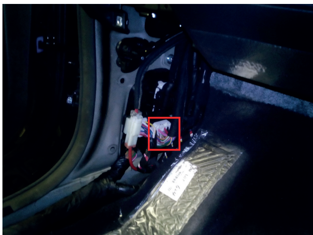
Рис.5 Место подключения к силовым цепям запуска двигателя
