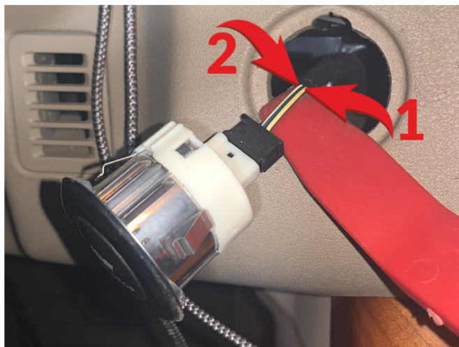
Подключения к кнопке Start/Stop: 1 – белый/синий провод, контакт №2; 2 – синий/белый провод, контакт №3.
