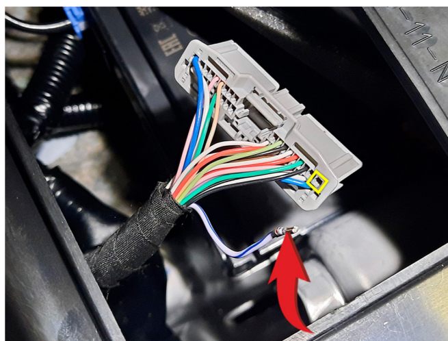
Питание блока +12 В (лиловый/синий провод, контакт №1)
