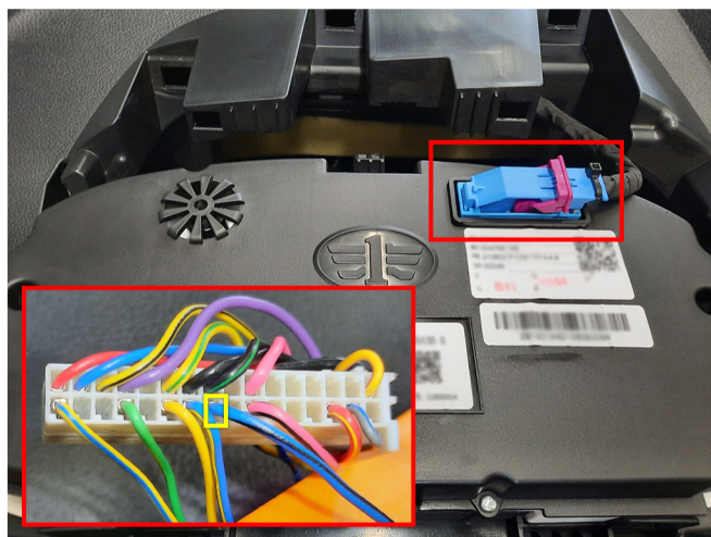
Подключение аналогового входа зажигания (синий/черный провод, контакт №24, «+»)
