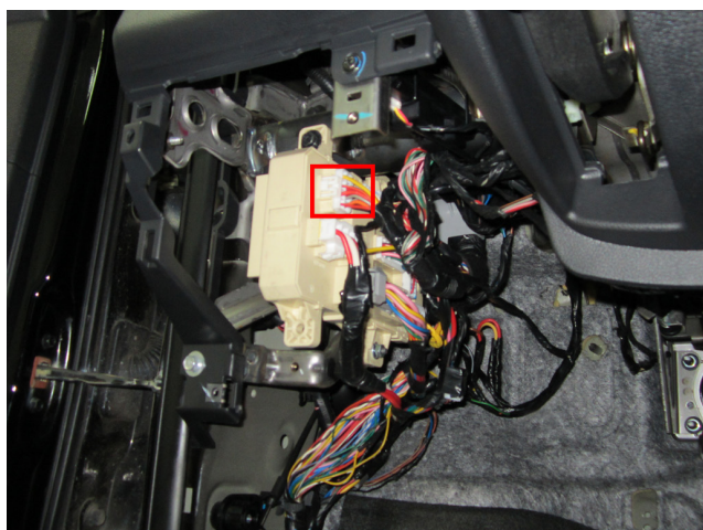
Рис.4 Место подключения к силовым цепям запуска двигателя
