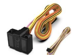
Предназначен для коммутации силовых цепей автомобиля при реализации функции автоматического запуска двигателя. Оснащен четырьмя малогабаритными электромагнитными реле. Для выполнения необходимых коммутаций доступны три группы нормально разомкнутых контактов и одна полная группа контактов. Подключается к сигнализации по принципу «разъем в разъем».
