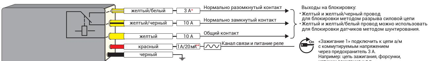
\* Максимальный ток через нормально разомкнутый контакт ограничен сечением (0,35 мм<sup>2</sup>) провода.
