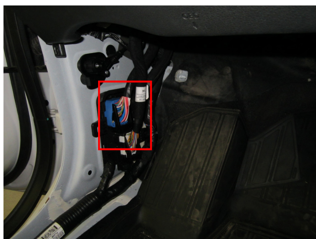
Рис.4 Место подключения к силовым цепям запуска двигателя
