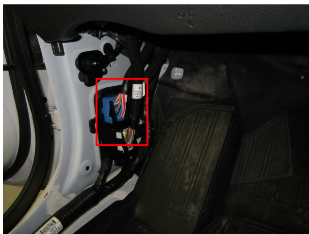
Рис.4 Место подключения к силовым цепям запуска двигателя
