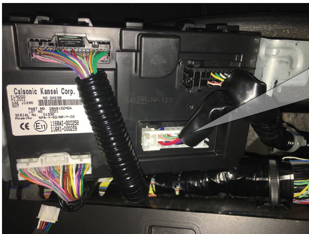
Рис.3 Место подключения к цепям запуска двигателя
