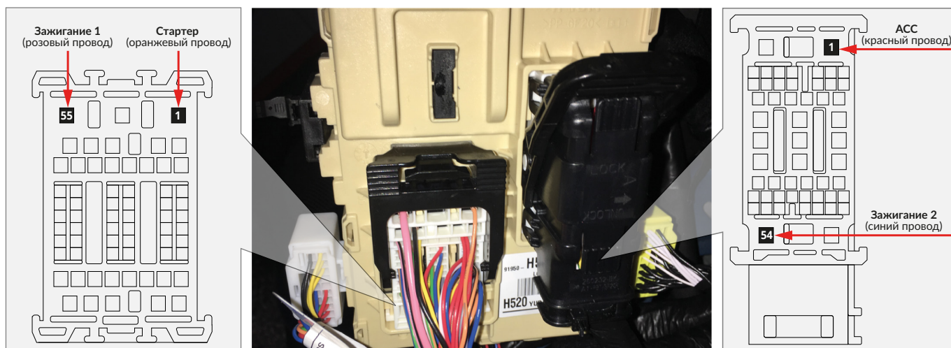
Подключение к цепям запуска двигателя
