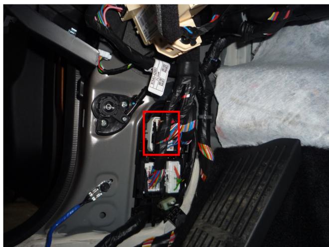
Место подключение к силовым цепям запуска двигателя
