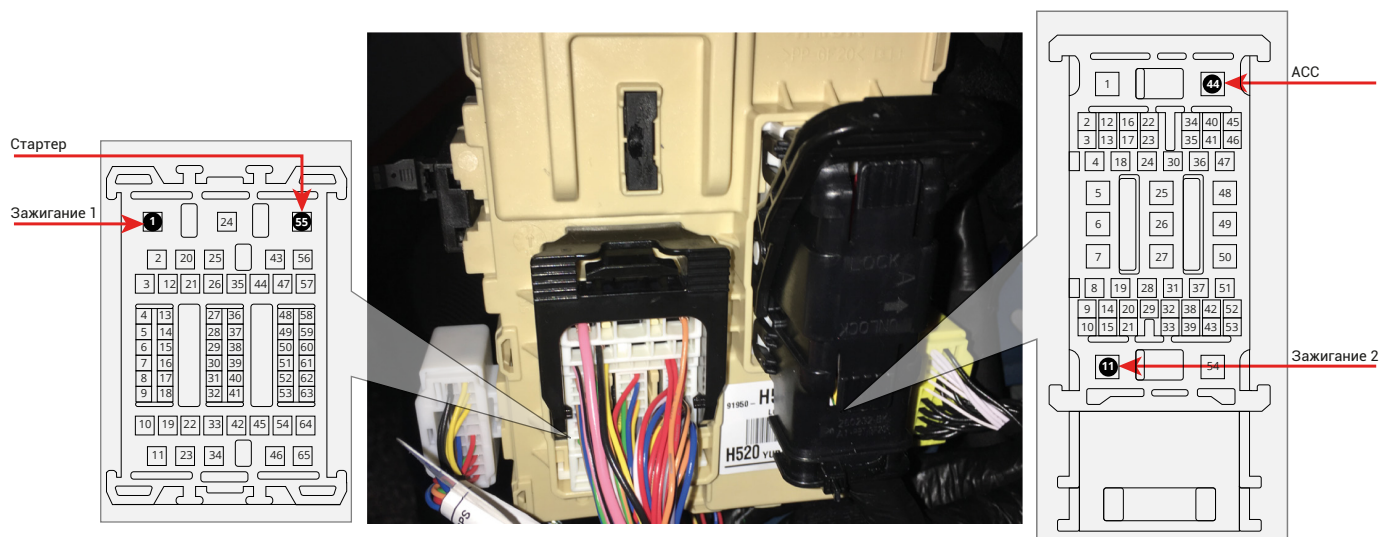
Место подключения к цепям запуска двигателя
