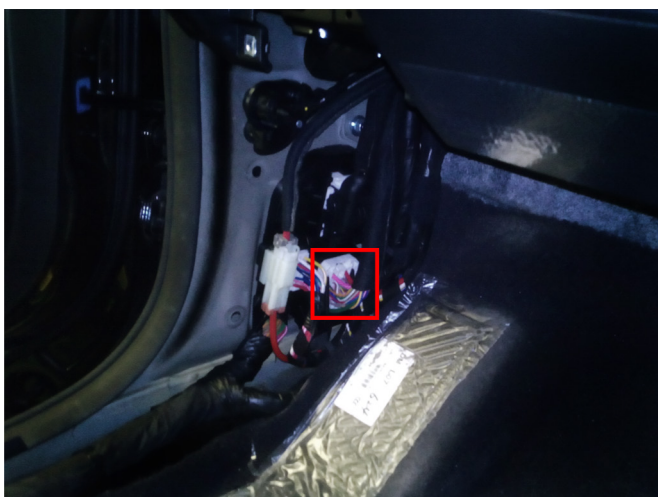
Место подключения к силовым цепям запуска двигателя
