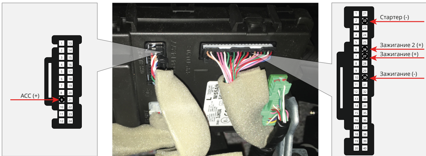
Место подключения к цепям запуска двигателя
