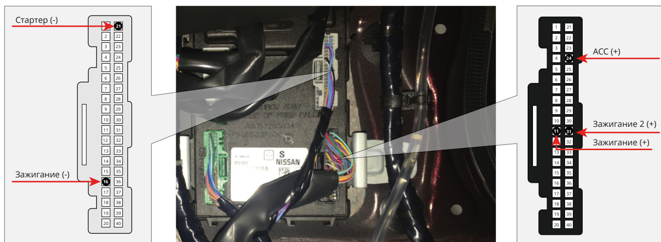
Место подключения к цепям запуска двигателя
