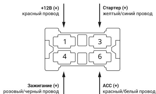
**i** Стартер подключается у замка зажигания в случае отсутствия провода в контакте №3 разъема блока BCM.
