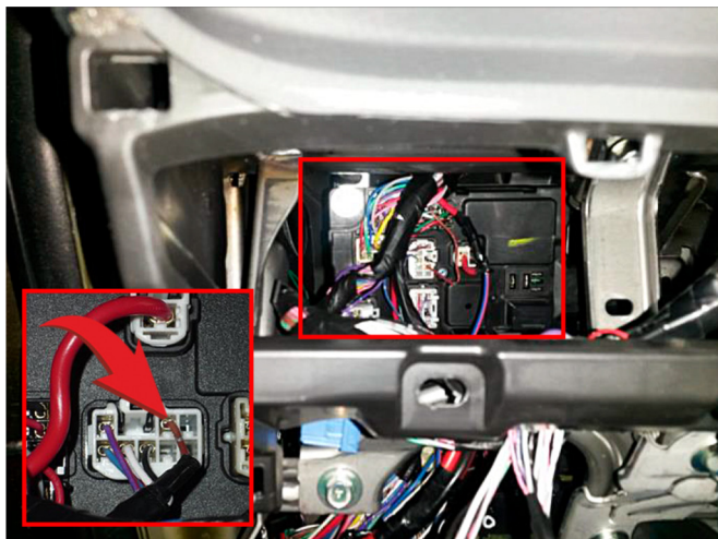
Подключение Зажигания (коричневый/красный провод)
