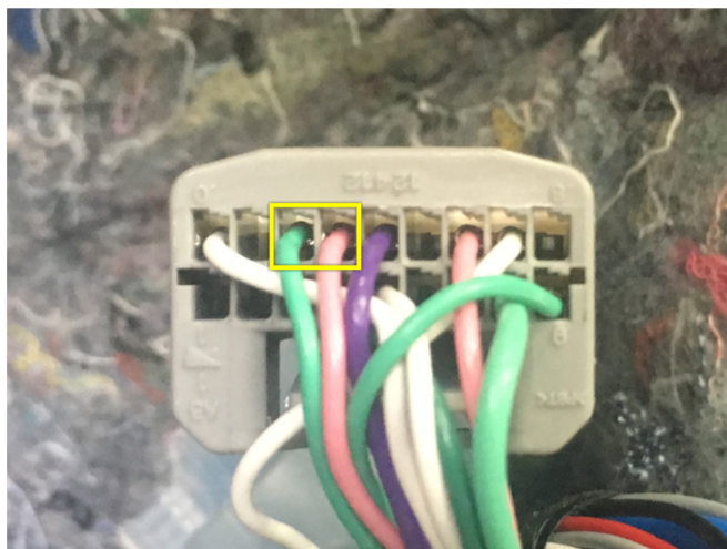
Подключение IMO (зеленый провод), IMI (розовый провод)
