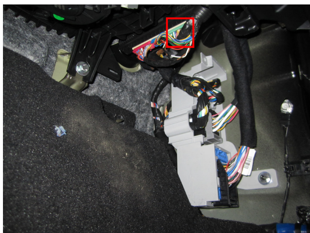
Рис.6 Место подключения к силовым цепям запуска двигателя -2
