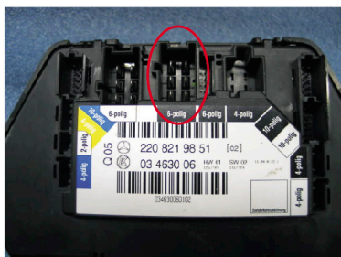
Рис. 2 Разъем джойстика сиденья, к которому производится подключение, и нумерация его контактов
