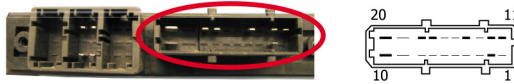
Рис. 4 Разъем блока управления сиденьем, к которому производится подключение, и нумерация его контактов
