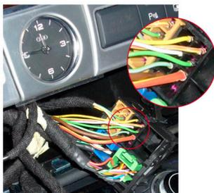
Рис. 3. Подключение модуля к автомобилю Audi A8 (2010--)
