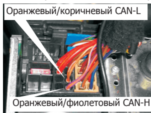
Рис. 2. Расположение контактов шины CAN в разъеме монитора на а/м VW Touareg, VW Multivan T5, VW Passat B6
