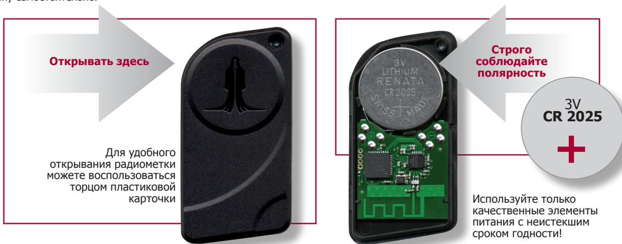
**!** При отрицательных температурах рабочие характеристики любых источников питания снижаются – замедляется химическая реакция. Из-за этого после длительного нахождения на морозе радиометка может не опознаться. Для восстановления работоспособности элемента питания достаточно согреть радиометку, а более точно – батарейку.
