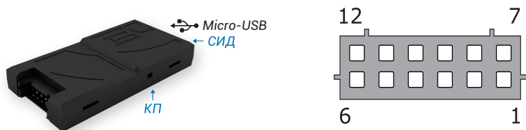
Рис. 2. Блок ССУ-Mazda и нумерация контактов в разьеме, вид со стороны проводов
