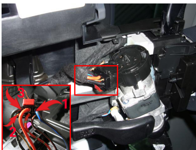
Рис.5 Место подключения к цепям запуска двигателя 1 – Зажигание 1 (черный/синий); 2 – Зажигание 2 (коричневый/зеленый); 3 – Стартер (черный).
