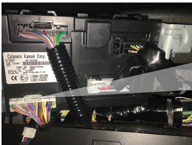
Место подключения к цепям запуска двигателя
