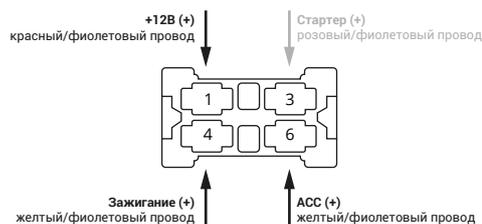
**i** Стартер подключается у замка зажигания в случае отсутствия провода в контакте №3 разъема блока BCM.
