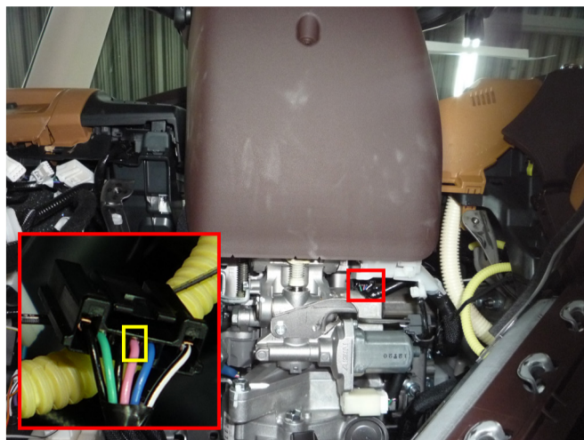
Разблокировка руля (розовый провод)
