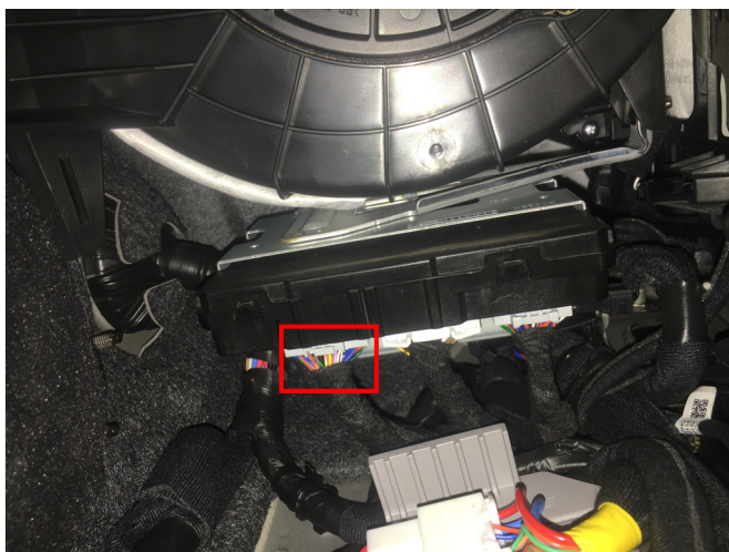
Рис.5 Место подключение к цепям замка зажигания
