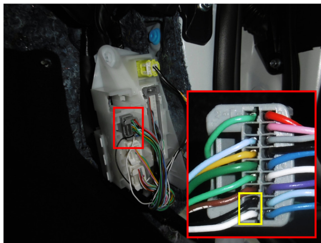
Рис.2 Подключение IMO (черный провод), IMI (белый провод)
