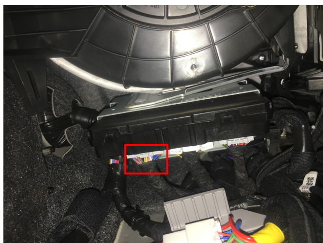
Место подключение к цепям замка зажигания
