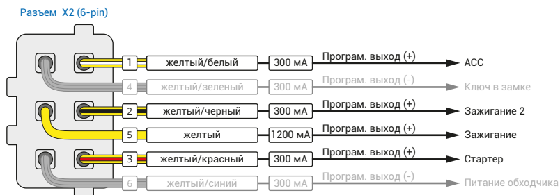
Рис.3 Подключение выходов автозапуска
