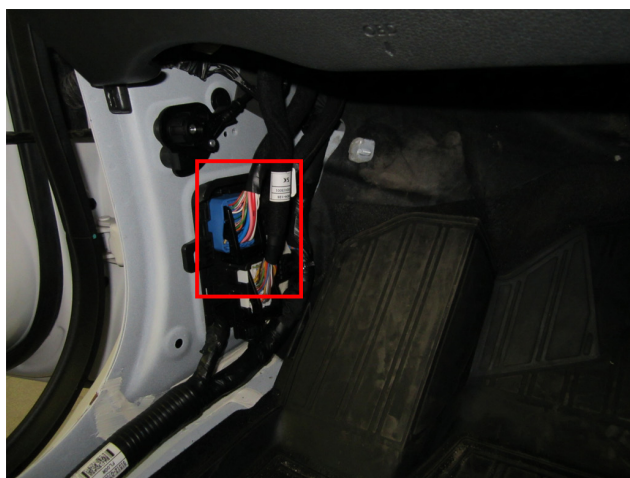
Рис.5 Место подключения к силовым цепям запуска двигателя
