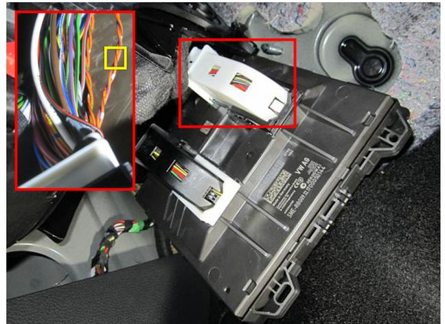
Рис.2 Подключение CAN2
