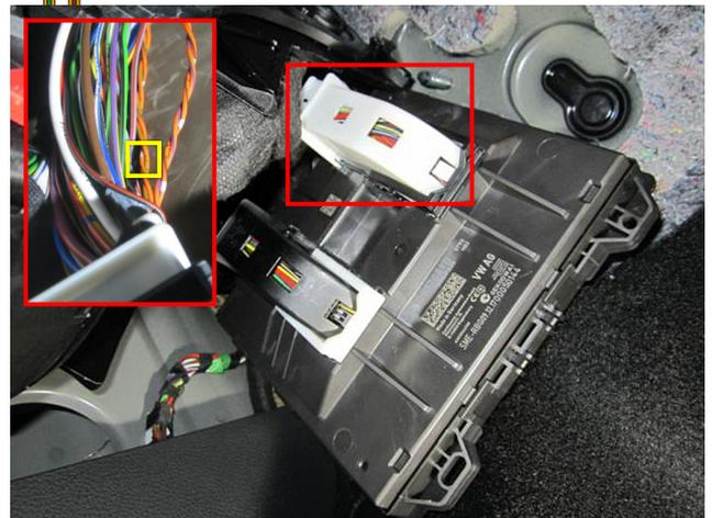
Рис.3 Подключение CAN1
