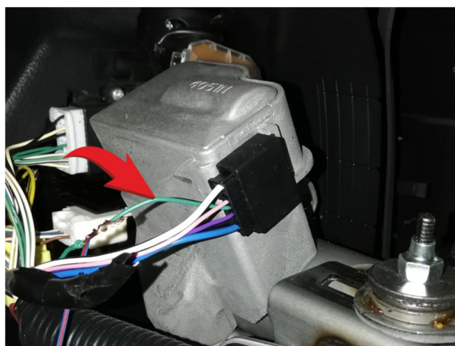
Разблокировка руля (зеленый провод)
