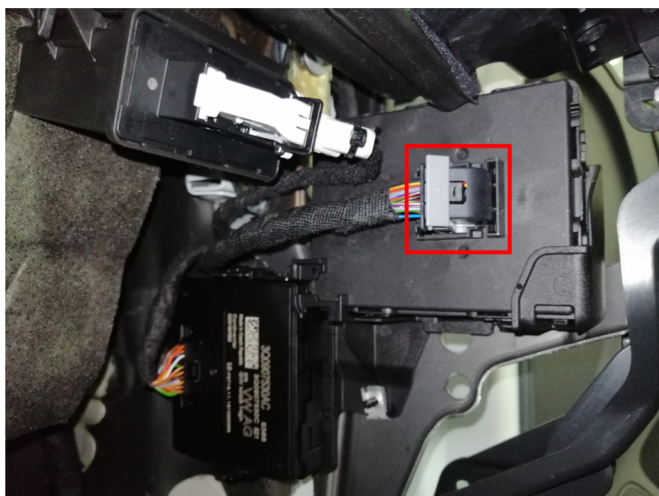
Место подключения к цепям зажигания
