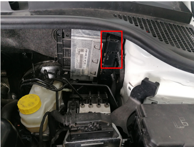
Вариант 2. Место подключения к стартеру
