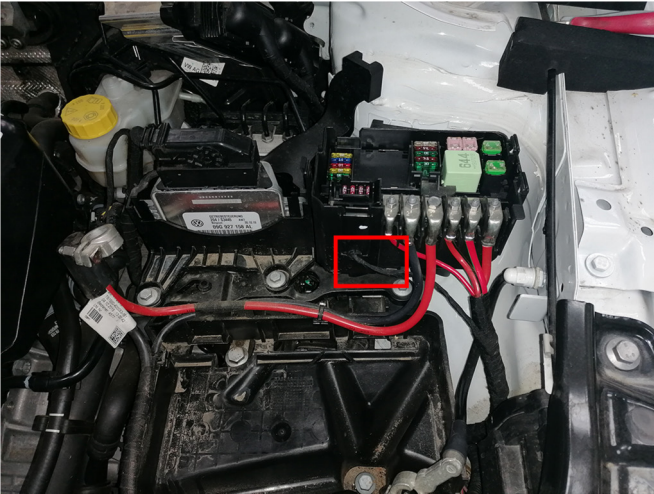
Вариант 1. Место подключения к стартеру
