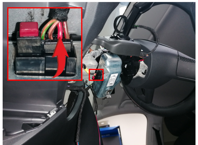
Подключения стартера коричневый/зелёный и коричневый/красный провода
