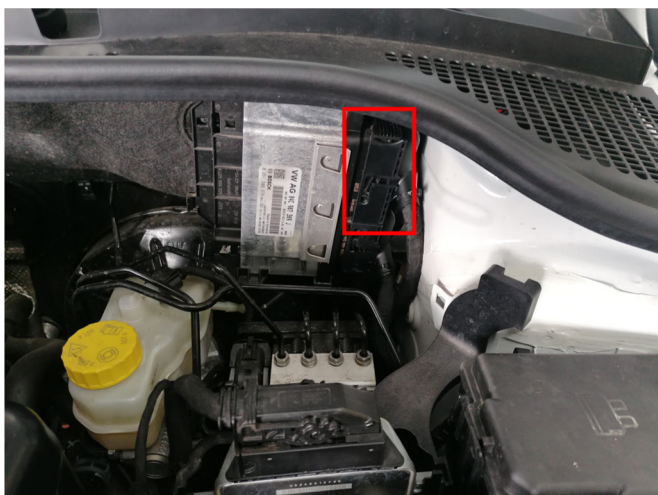
Вариант 2. Место подключения к стартеру
