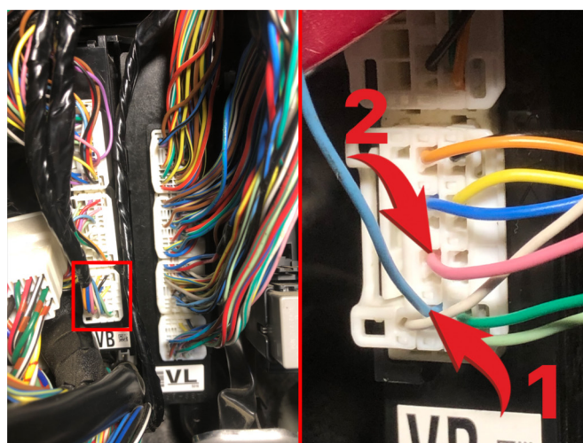
Подключения к цепям запуска двигателя: 1 - Зажигание 1 (голубой провод); 2 - Стартер + (розовый провод).
