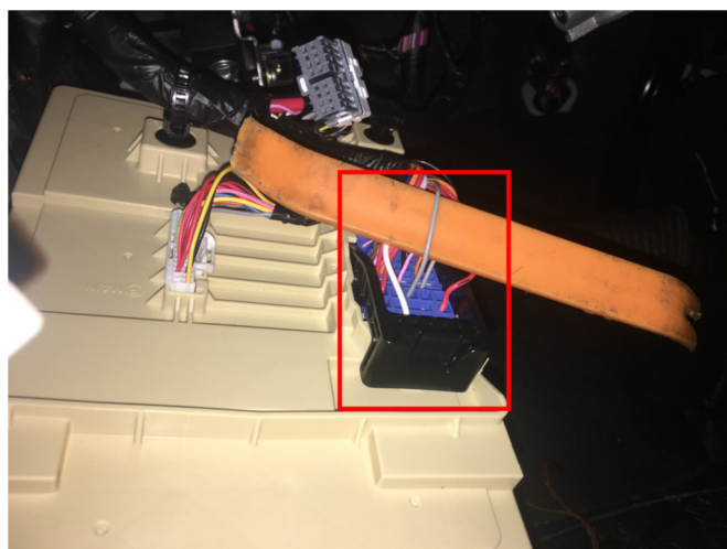
Место подключения к цепям запуска двигателя
