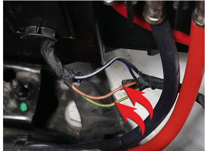
Подключения стартера коричневый/зелёный и коричневый/красный провода
